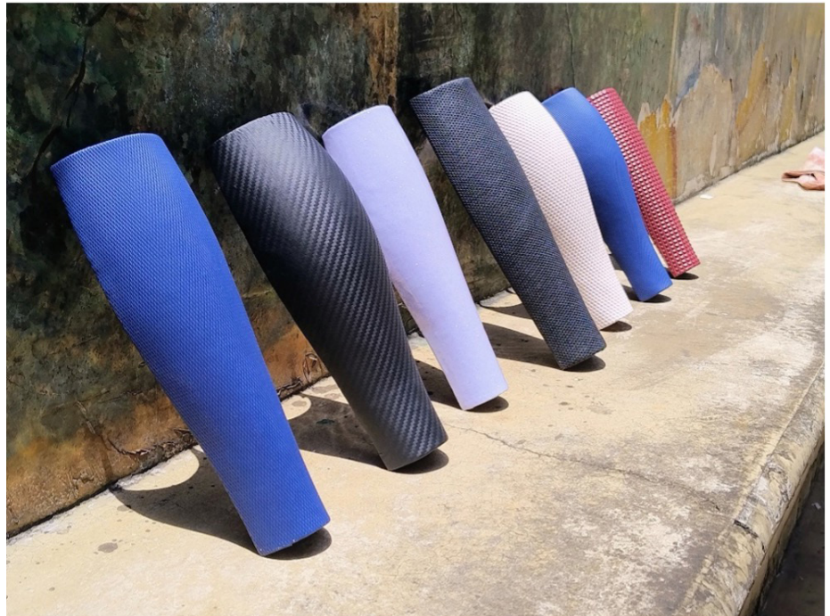
Figura 3 Mockups em fibra de vidro e resina poliéster revestidos com vinil texturizado
