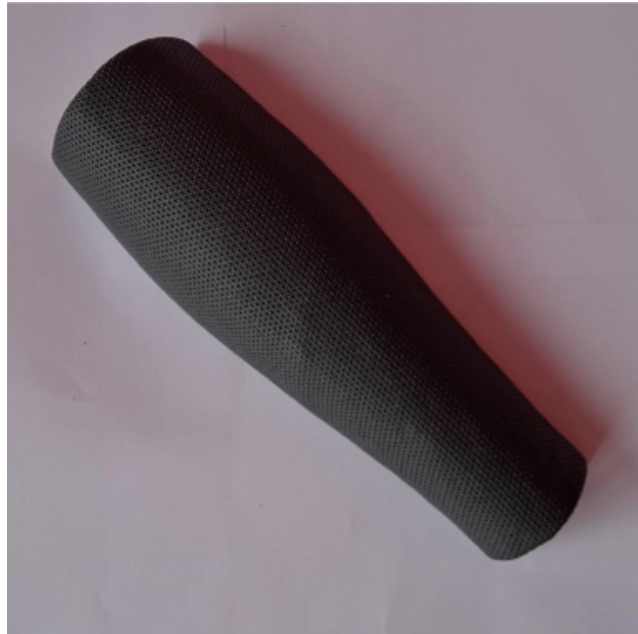
Figura 2 Mockup em atadura gessada recoberto com película de vinil texturizado
