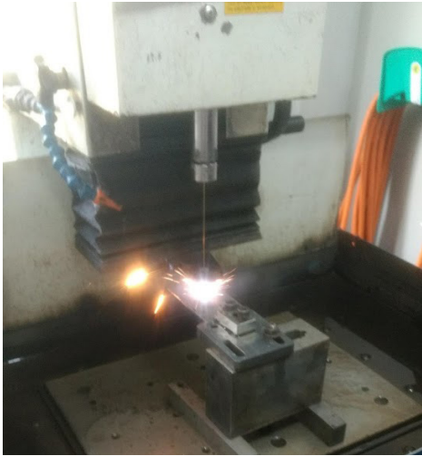
Fig 8. Processo de preparação da largada e execução por eletrodo para o passe do fio da eletroerosão Fonte: Autor (2020)
