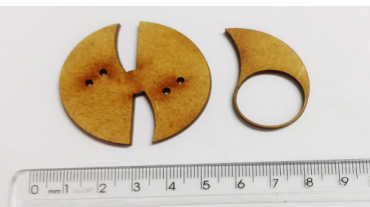
Fig 16. Obtenção dos Mockups em MDF para os testes de usabilidade e interação com os usuários. Fonte: Autor, 2020
