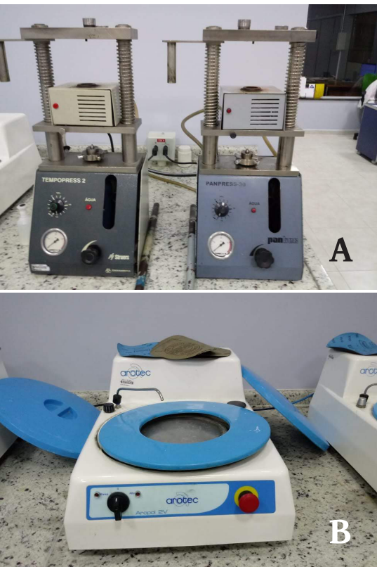
Figs 5A e 5B. Embutidora para embutimento a quente das amostras e Politriz utilizadas para a preparação da superfície do material Fonte: autor (2020)
