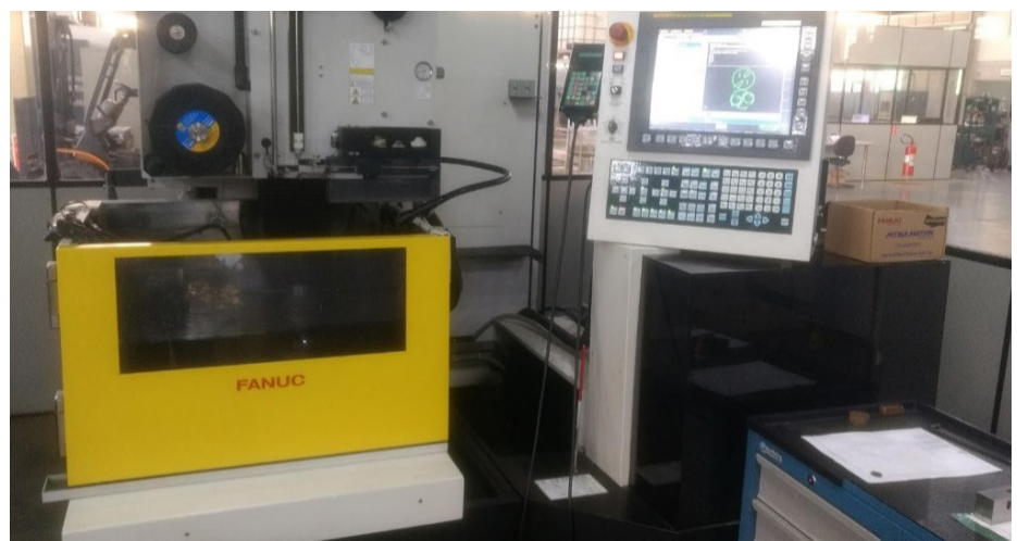
Fig 7. Equipamento de Manufatura Integrada para a eletroerosão a fio, tipo Fanuc \alpha -C400iB Fonte: autor (2020)
