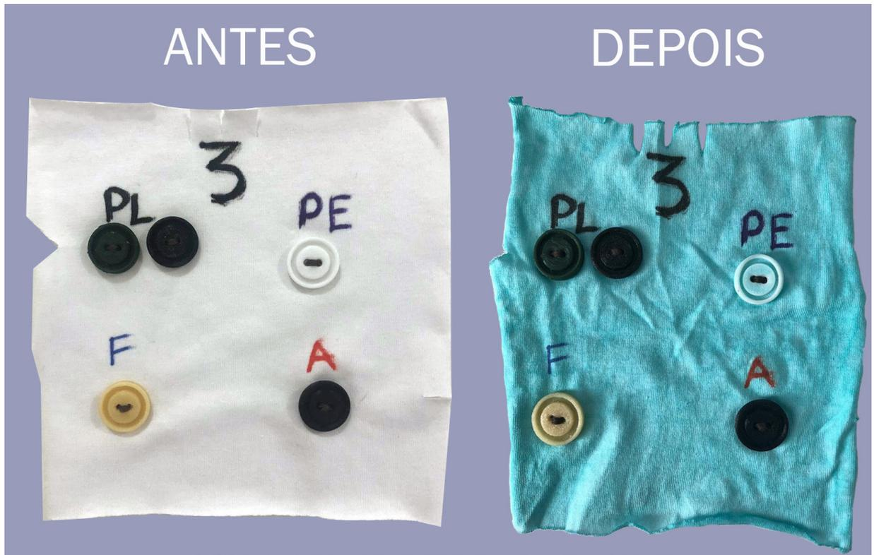
**Figura 8** Teste dos botões no tingimento a seco
