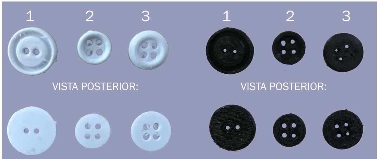
**Figura 4** Teste botões de furos na impressora Cliever
