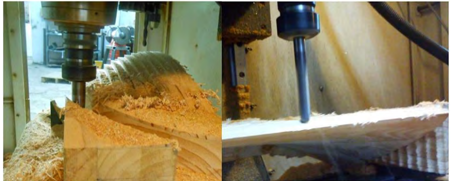
Figura 3 Corte das lâminas de uma turbina hidrocinética sendo realizada em um centro de usinagem padrão
