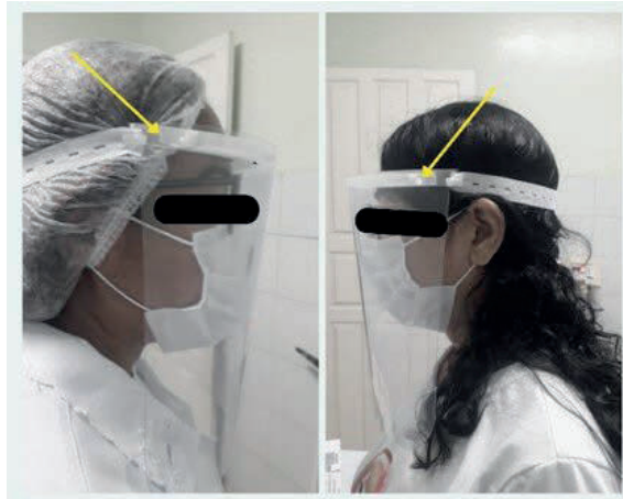
Figura 23 Utilização do Protetor PFC e a indicação do suporte da viseira relatado como rígido. Fonte Dos autores, 2022.
