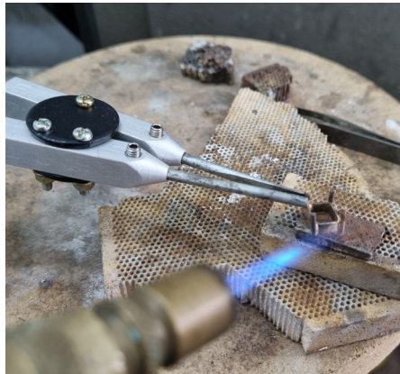
Figura 21. Pinça articulada do tipo “terceira mão”, usada para manter peças no lugar.
