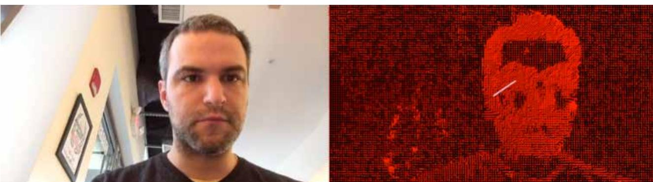
**Figura 5** Exemplo de estimativa de movimento; A: Imagem captada pela webcam; B: representação da matriz de vetores.
